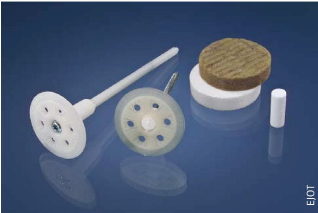
Fig. 18 Fixations à rosace accompagnées d'un bouchon isolant ou de rondelles isolantes permettant de limiter le pont thermique.
